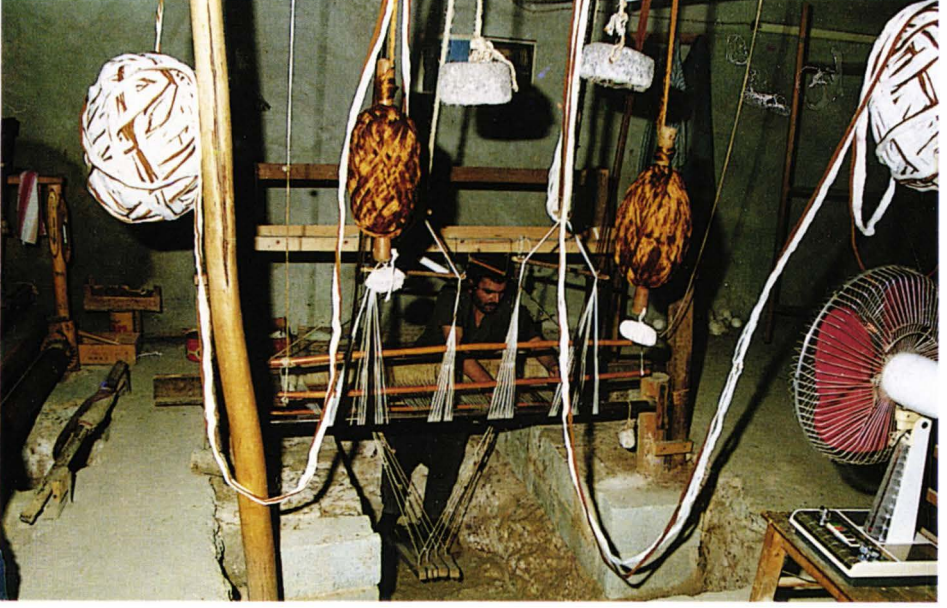
Şekil 26 Ayaklara Basarak gücülerin hareket ettirilmesi
