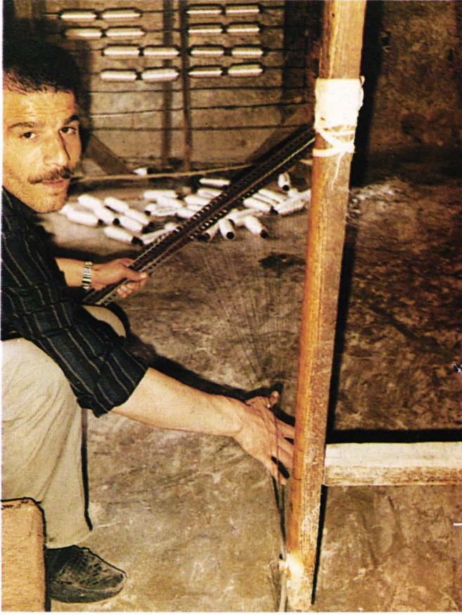
Şekil 23. Çözgünün Dolaba Takıldığı Yerin Gösterilmesi
