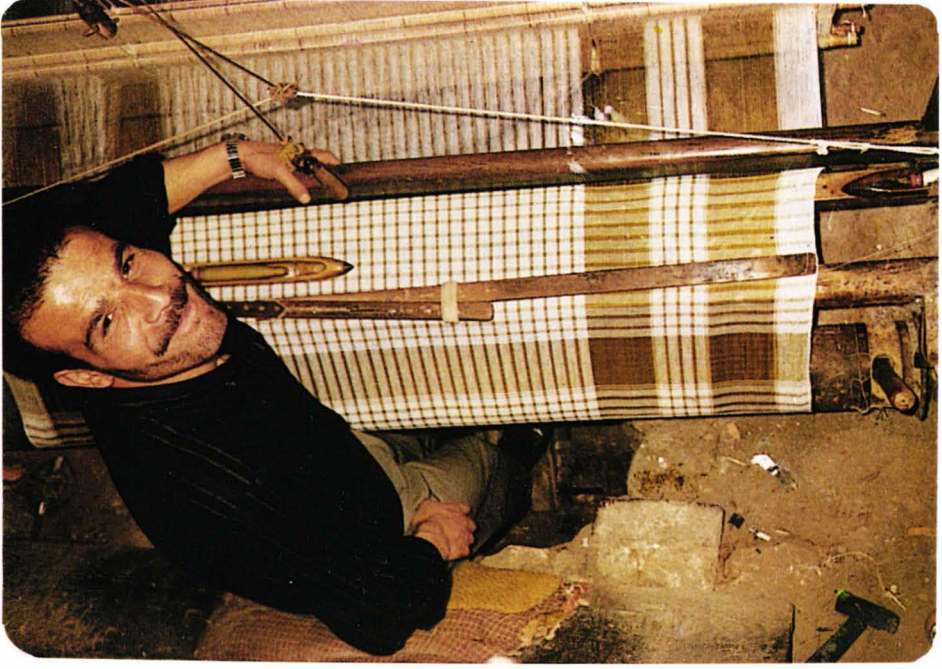
Şekil 8. Culha Dokuyan Dokuyucunun Dokuma Parçası Üzerinde Mekik Görülmektedir.
