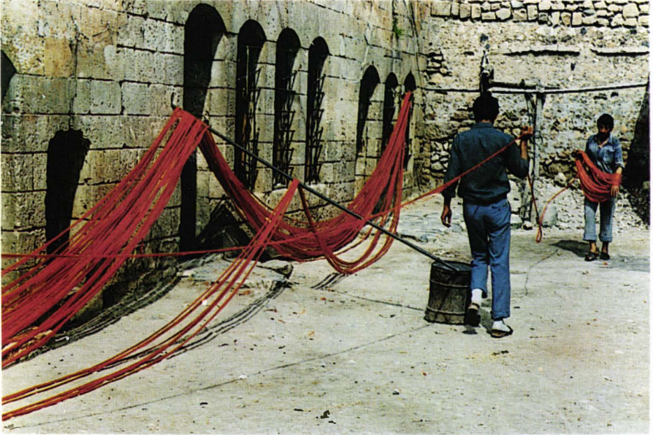
Şekil 21. Kurutulan İpliklerdeki Ara Destekler ve İplerin Açılarak Kurumaya Hazırlanması
